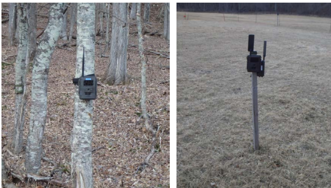
写真 3-16 わな付近の森林や草地に設置した通信型自動撮影カメラ
