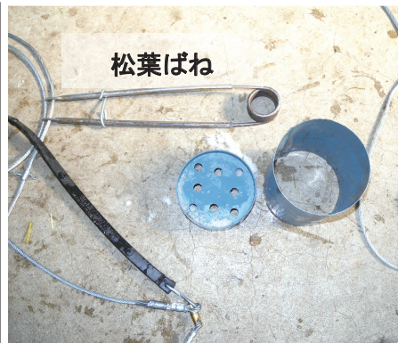
図 8. 松葉ばねを用いたくくりワナ.
