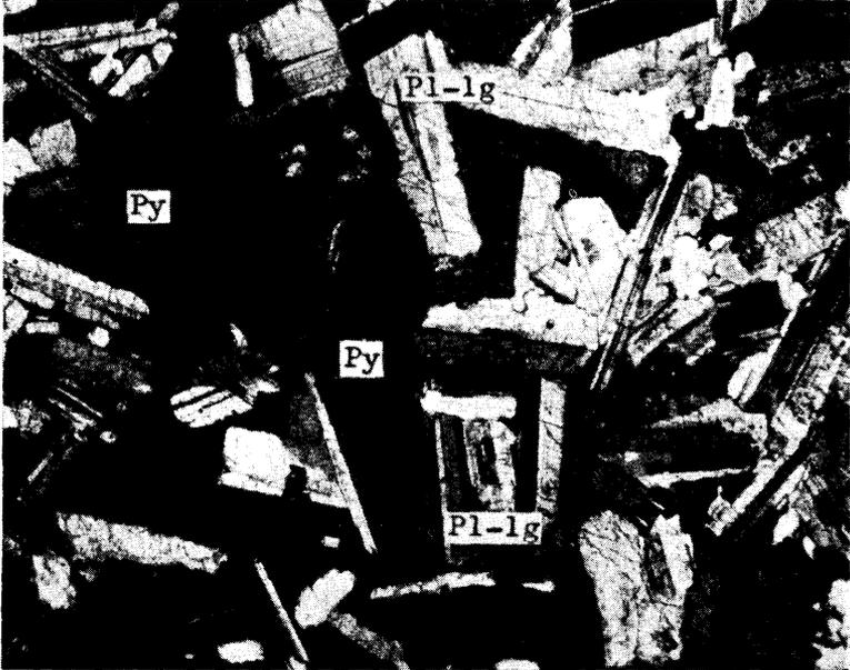
第24図 斑禱岩中の、橄欖石のない部分，長柱状の細い斜長石と，間を埋める単斜輝石の大晶からなる。(シルコマナイ沢入口，太田)
