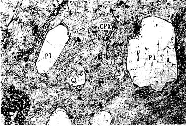
第28図 藻別層富美石英安山岩の顕微鏡写真（フミ川）横幅は3mm C p x : 単斜輝石、P 1 : 斜長石、Q : 石英
