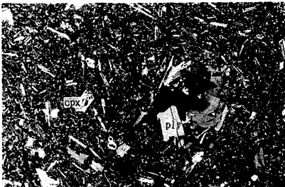
第57図 南ノ沢玄武岩の顕微鏡写真。 横幅は3mm（直交ニコル）。 pl；斜長石， cpx；単斜輝石。
