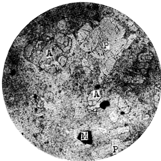
第21図 含かんらん石紫蘇輝石普通輝石安山岩 (1,050 m 山東中腹)
