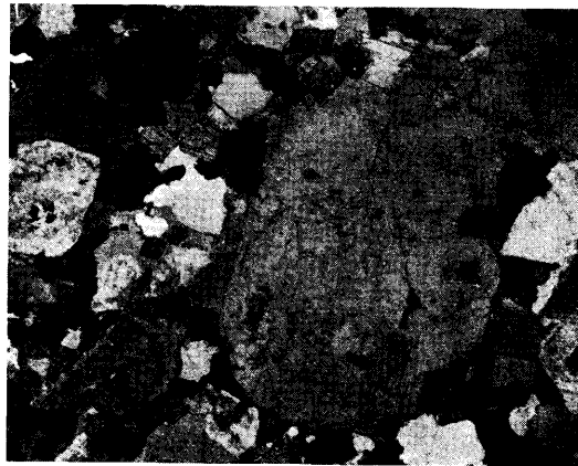
第23図 花崗岩質ミグマタイト中の斜長石斑状変晶の顕微鏡写真 ×27
