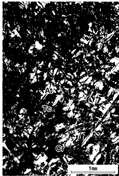
第13図 塊状蛇紋岩 (B-28) クロスニコール At: アンチゴライト, Cr: クロム鉄鉱, Tc: 滑石
