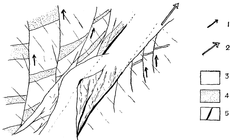
第7図 ダイクズの逆断層の例 (銭亀沢鉱山)
