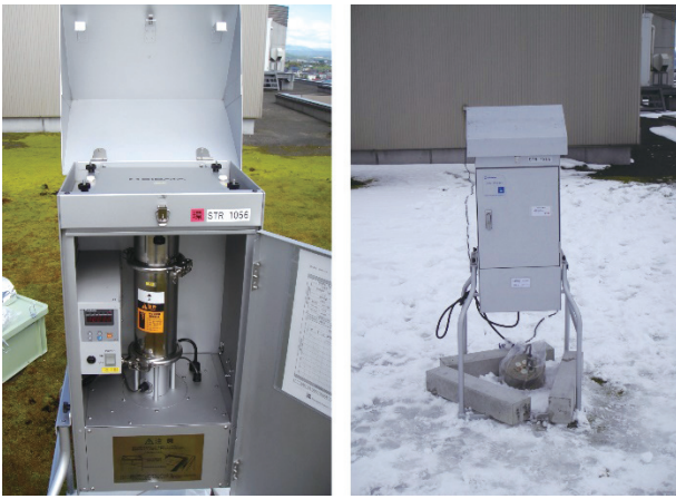
図2 ハイボリウムエアサンプラーによる大気試料の採取
