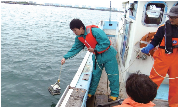
図3 エクマンバージ採泥器を用いた港湾の泥(底質)の採取
