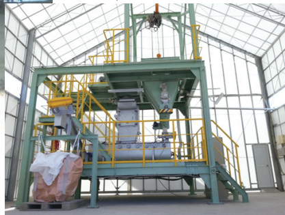
ライムケーキを排煙処理剤として再資源化 (上図は消石灰製造装置)
