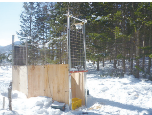
試験捕獲に用いた小型囲いワナの試作機
