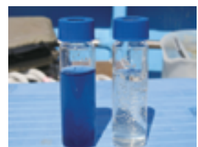
サロマ湖最深部での底から1m層水(左)と2m層水(右)の船上でのメチレンブルー法による硫化物測定(平成24年9月)。底1m層には大量の硫化物が存在!
