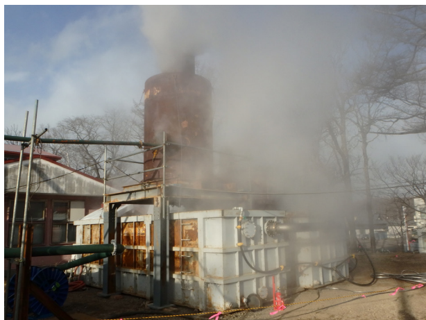
写真 蒸気を含む熱水が湧出した TS 井の能力試験 町内での有効利用が期待されています。
