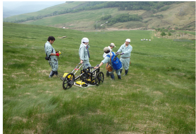
写真1 地中レーダー探査の実施風景
