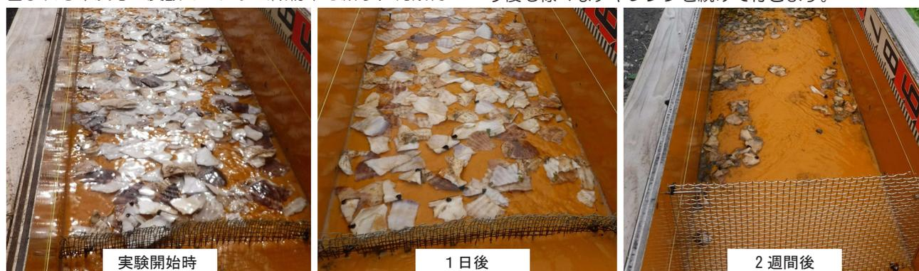
水路に敷き詰めたホタテ貝殻には鉄の沈殿物が付着することは無く、坑内水との反応が続き、実験開始から2週間程度で、そのほぼ全量が溶けて無くなってしまいました。坑内水の流れの向きは、手前から奥の方向です。
