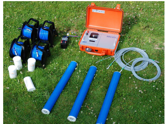
写真 当所所有と同型の MT 法探査装置一式（装置説明書より）
