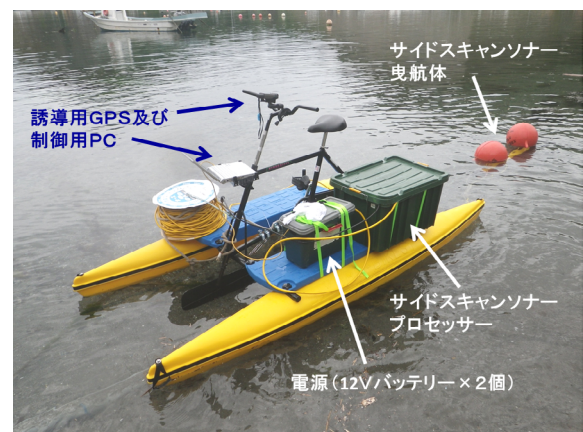
写真 人力式双胴船と搭載した機材
