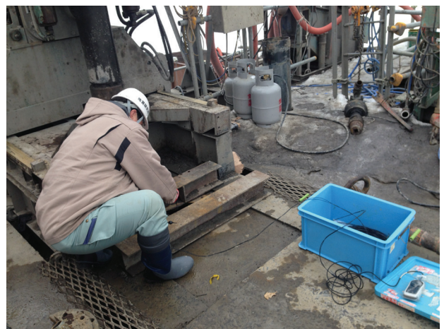
井戸の中に温度計を入れて地下の温度を測定
