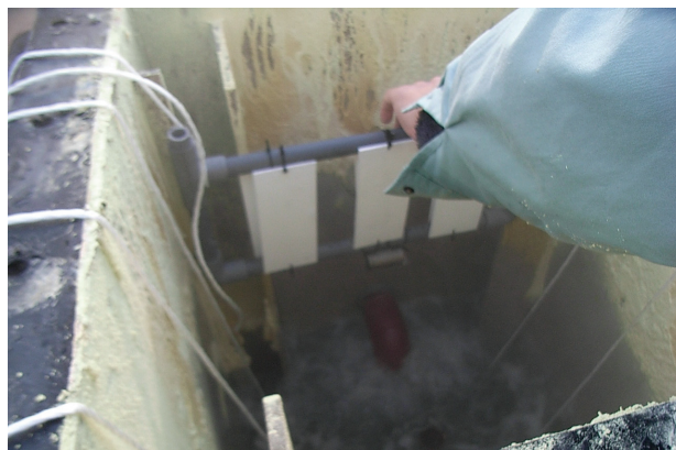
図6 熱交換器材料試験片の設置状況（川湯温泉）
