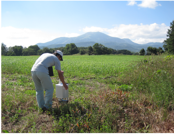
▲図3 地下構造を調べるため重力を測定しています
