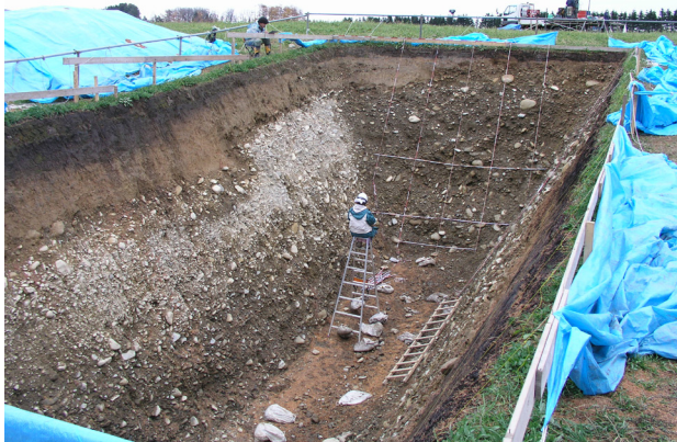
図2 十勝平野断層帯でのトレンチ調査
