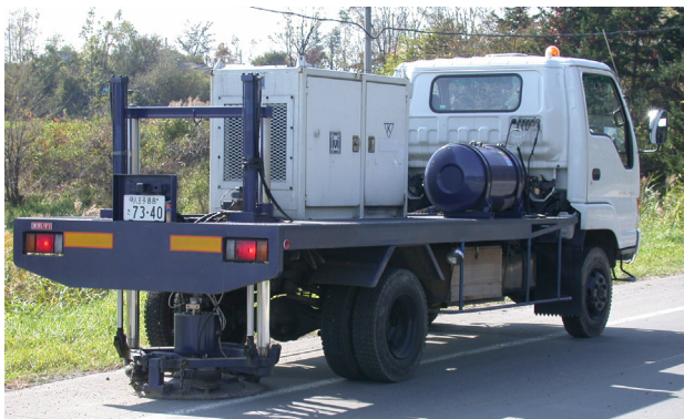
図3 十勝平野断層帯での反射法地震探査
