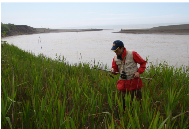
北海道沿岸での津波堆積物調査の様子。検土杖という道具で津波堆積物を探しているところ。
