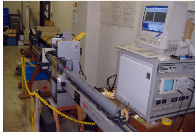
写真1 MSCL装置。コア試料を非破壊で連続解析できる。中央のレール上にあるのが、塩ビに入ったコア試料。
