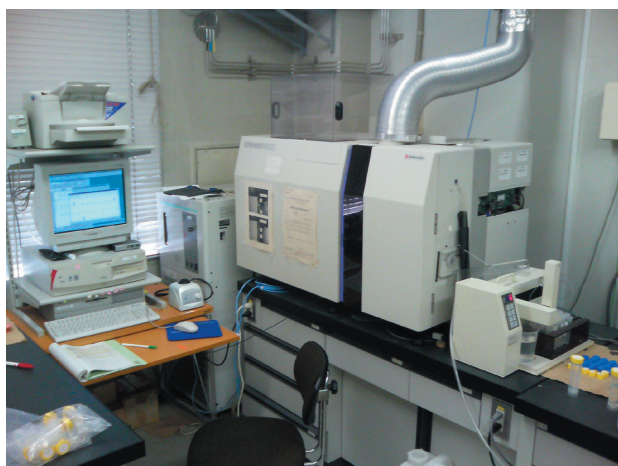
図 分析に使用した ICP 質量分析装置。元素によっては ppt(1 兆分の 1) のオーダーで濃度を測定することが可能。
