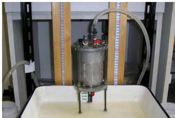
写真 2 室内透水試験のようす
