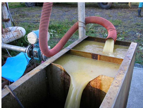
写真4 豊富温泉における揚湯試験の様子
