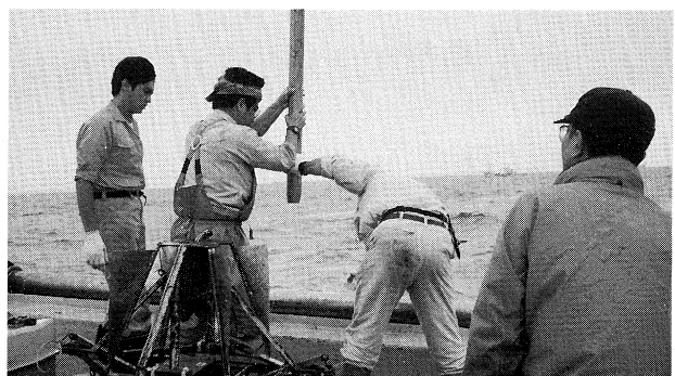
東京湾での底質調査(柱状採泥調査)
