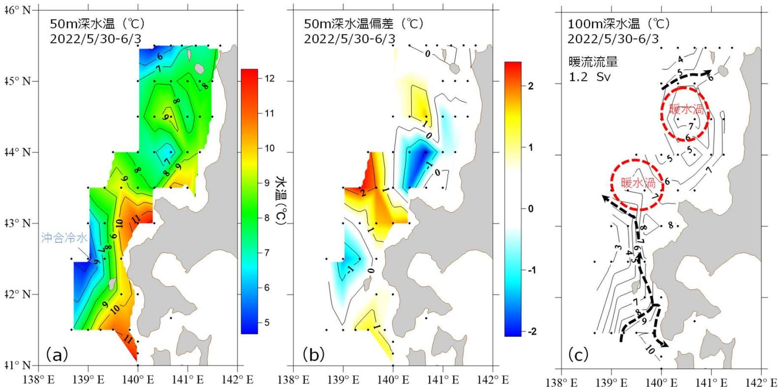
図1 2022年5月下旬～6月上旬における (a) 50m深水温 (b) 50m深水温偏差の水平分布、(c) 100m深水温の水平分布と対馬暖流の流路（矢印）。水温偏差は過去30年（1989年～2018年）の平均値から算出。流量の単位はSv（=1×10<sup>6</sup>m<sup>3</sup>/s）。
