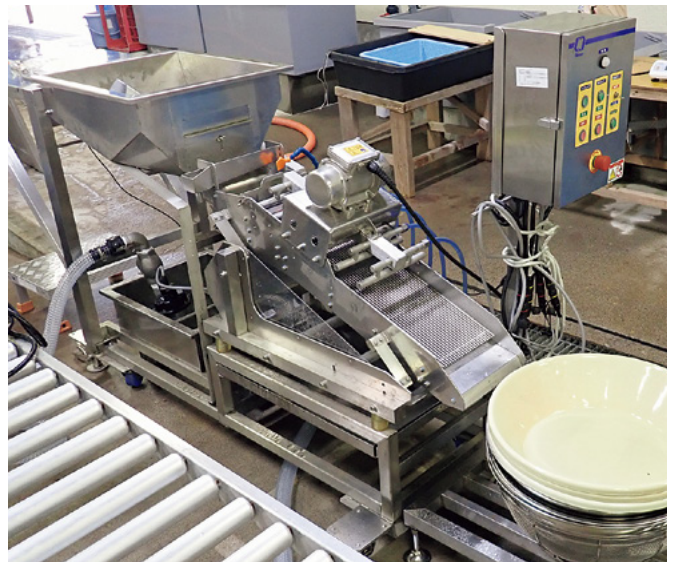
親魚から稚魚への感染を防ぐために開発した洗卵システム
