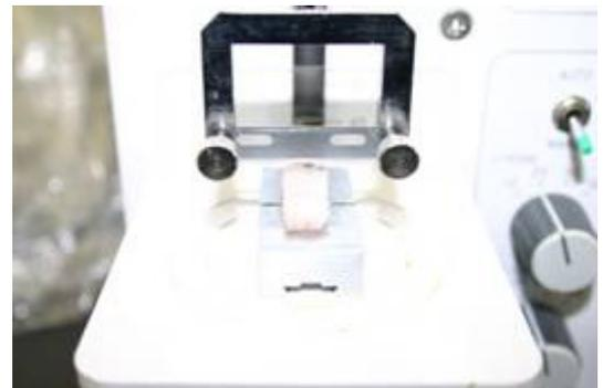
破断強度の測定
