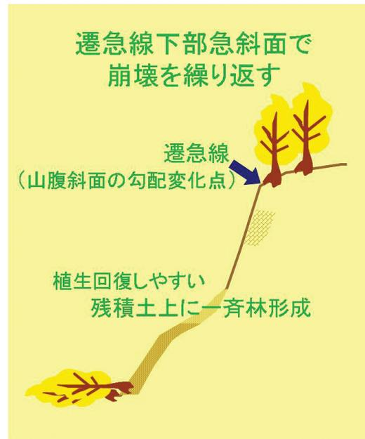
図-25 砂岩、泥岩地帯の崩壊の特徴
