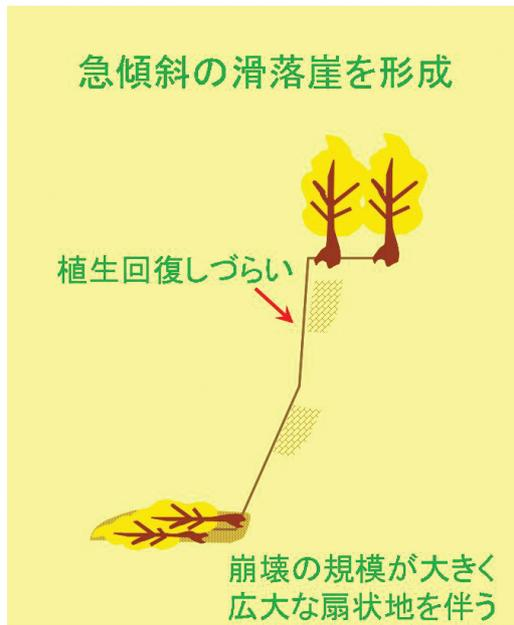
図-24 輝緑岩質礫岩、粘板岩地帯の崩壊の特徴
