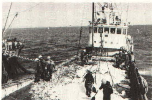
⑦ 揚網開始後、約1時間。4つのダンブルがイワシでいっぱいになった。ダンブルは、すばやくフタがされ、ウインチからは、モッコがはずされる。
