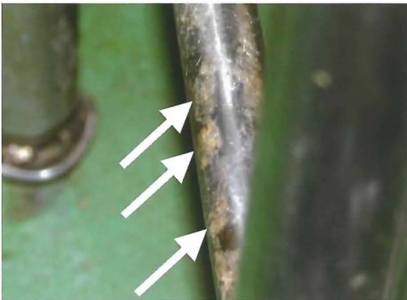
図1 ステンレス製作業台に付着したバイオフィーム（矢印で示した茶褐色の汚れ）
