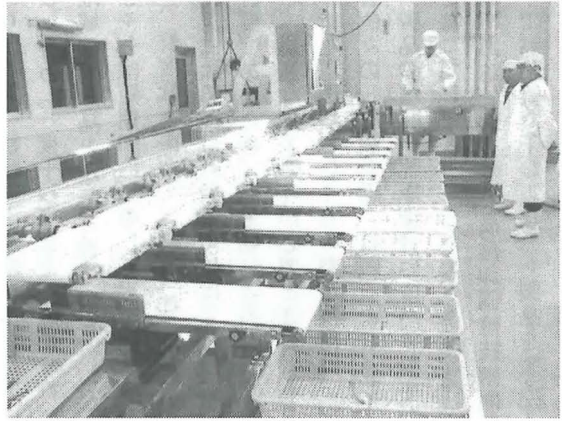
図2 自動選別機導入による作業工程の改良
