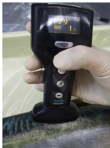
写真2 フィッシュアナライザによる測定
