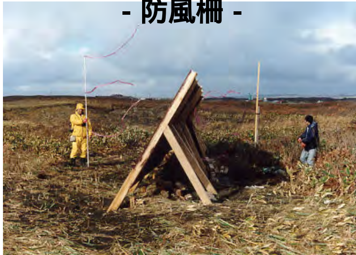
防風柵の機能測定試験(天塩町)
