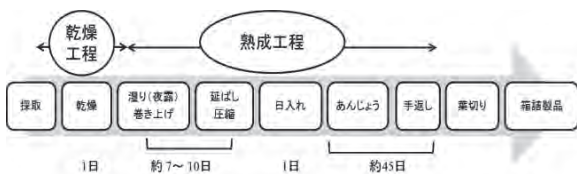
図1. 羅臼コンブ乾製品の製造工程の概略と平均的な作業日数
