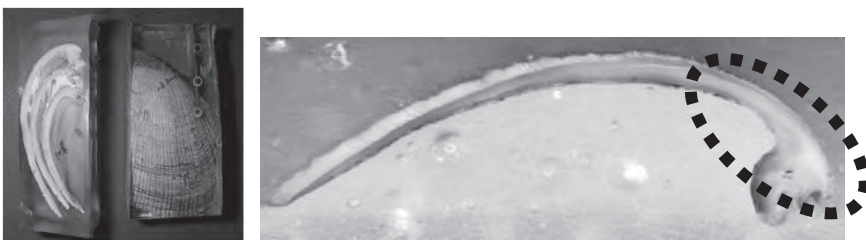
図6 ポリエステル樹脂に包埋した貝殻 点線で囲まれている部分は摩耗部分を表す
