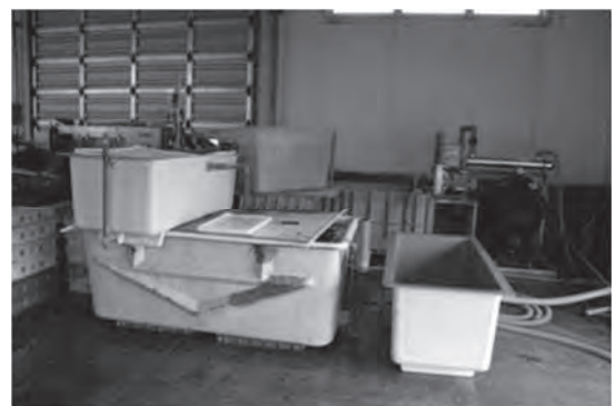
写真2 湾中漁協における水槽の配置 (奥:貯水、手前上段:産卵、下段左:採苗・飼育)
