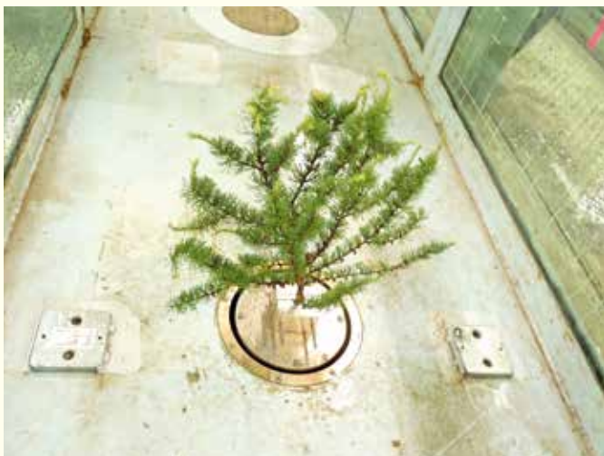
流水中の樹木が受ける力を測るための水路実験装置（幅1m×高さ1m×長さ20m）内に固定されたグイマツ枝葉。
