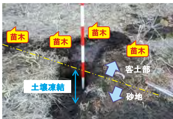
写真3-2 土壌による融解時期の違い 客土には火山灰土が用いられています。 客土部は凍っているが、砂地は凍っていません。 苗木はすでに枯死しています。(2003年3月24日撮影)
