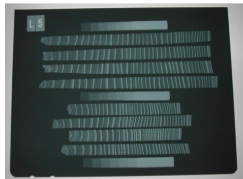
材の軟X線写真 色の暗い部分が早材、色の明るい部分が晩材
