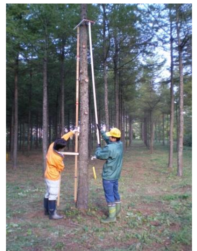
幹曲りの調査風景 4m高の直径(右)と最大矢高(左)を測定している。
