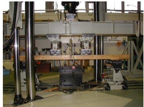
実大強度試験機による曲げ強度試験
