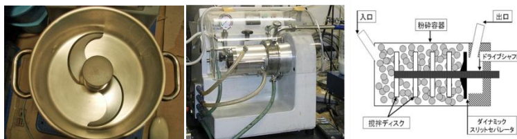
図1 カッターミル（微細化：左）と湿式メディアミル（超微細化：右）
