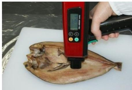
写真 光センサーによる脂の乗り測定
