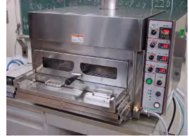
写真 過熱水蒸気発生装置
