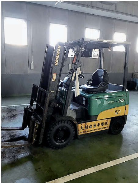
図3.2.2 計量機能を持つ電動フォークリフト
