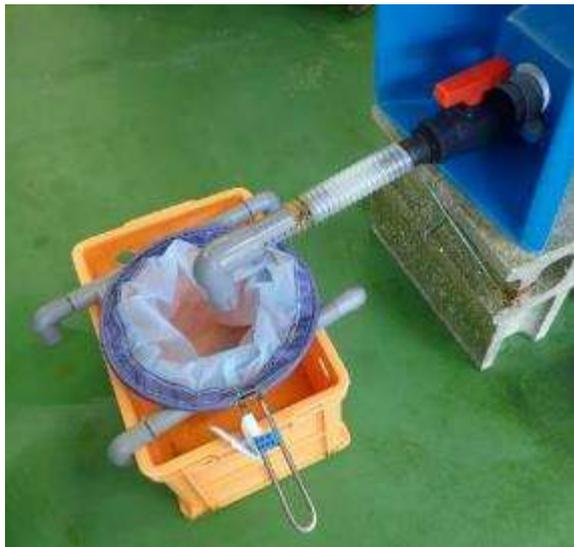
図17. アルテミア孵化槽の下部にプランクトンネットを設置した様子
