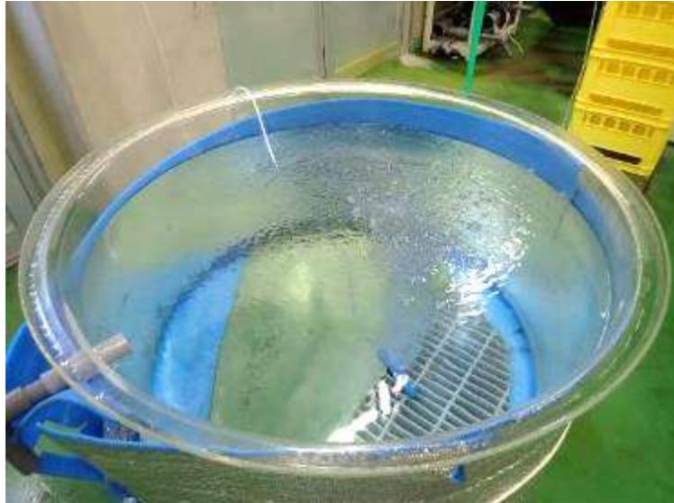
図3. 吐出量 7L/min のエアープンプで 500L ポリカーボネートタンクに通気した状態
