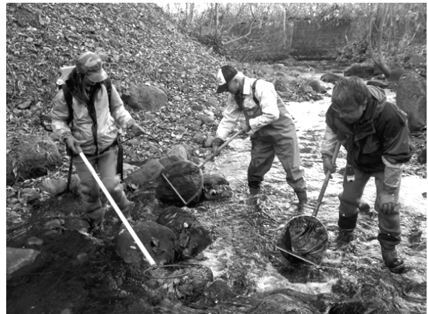
図 2 エレクトロ・フィッシャーによる魚類採捕の様子
