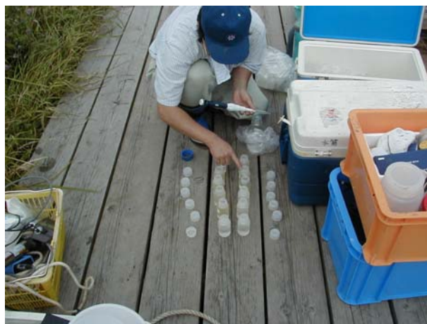
写真5 サンプリング水の現地での前処理
