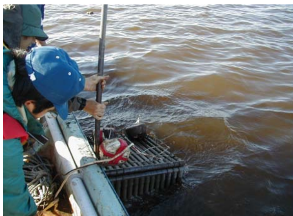
写真4 連続水質記録計の沼内への設置
